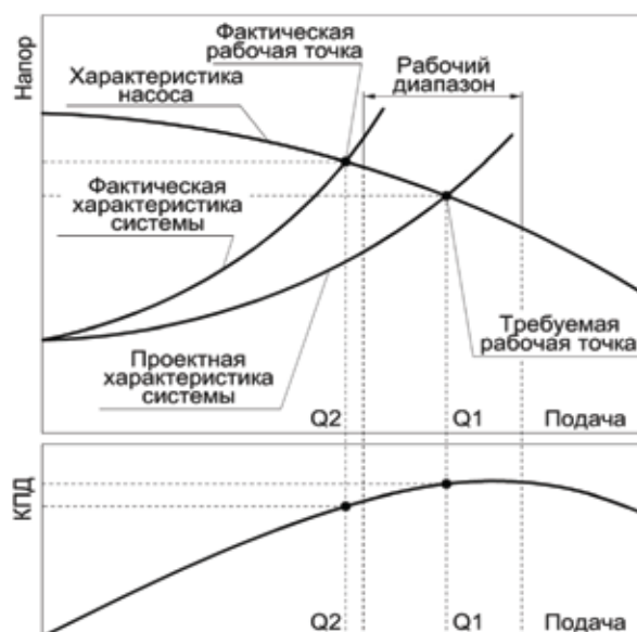
Рис. 12. Работа насоса при пониженной подаче
