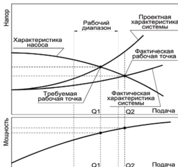
Рис.10. Работа насоса при повышенной подаче
